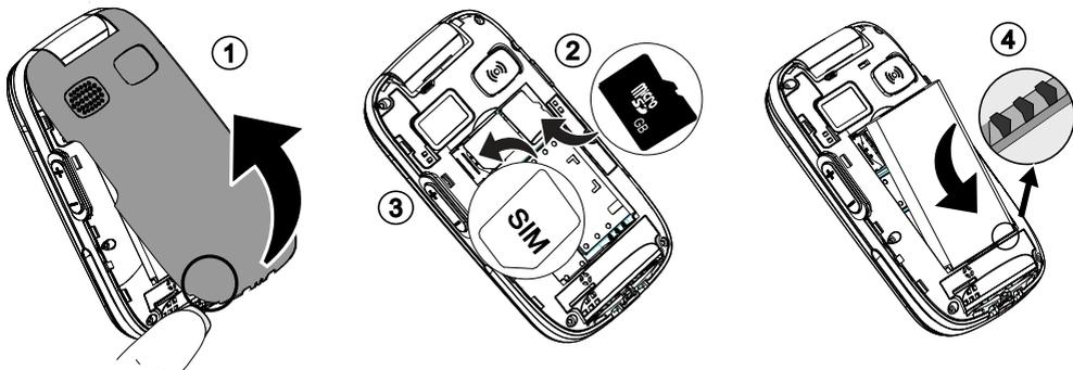
1. Retirez le couvercle de la batterie. Attention à ne pas vous abîmer les ongles lorsque vous retirez le couvercle. Attention à ne pas tordre ou déformer le couvercle, au risque de l'abîmer. Retirez la batterie si elle est déjà installée.
